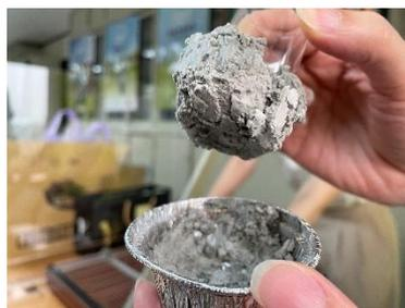
5. 膨潤土底部以針輕輕插入，測試是否有水流出
