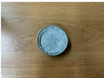
3. 將小玻璃瓶倒置於鋁箔容器內的膨潤土上靜置一段時間
