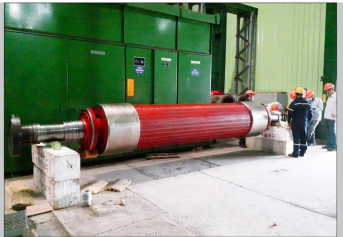
發電機轉子(紅色)拆下後離廠的輻射偵檢。
