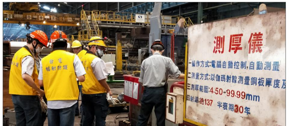
放射試驗室同仁以伽瑪射線進行鋼板厚度量測。
