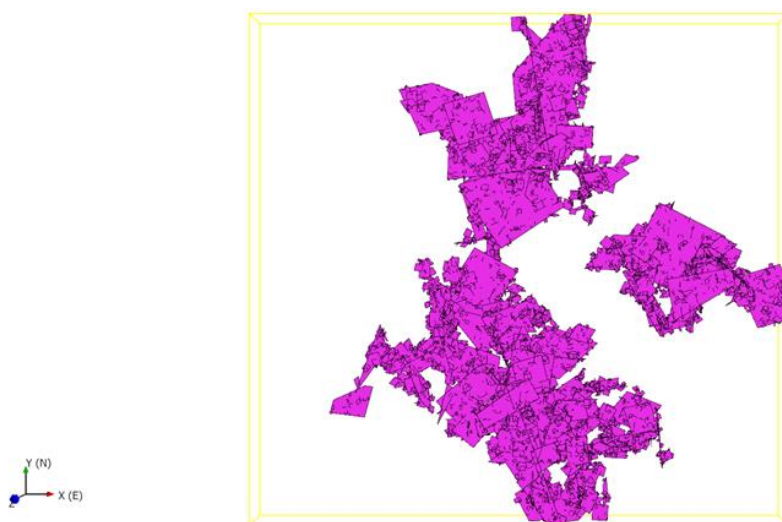
圖 9-7：FracMan 讀取 DarcyTools 輸出近場區域裂隙並分析其裂隙連通性
