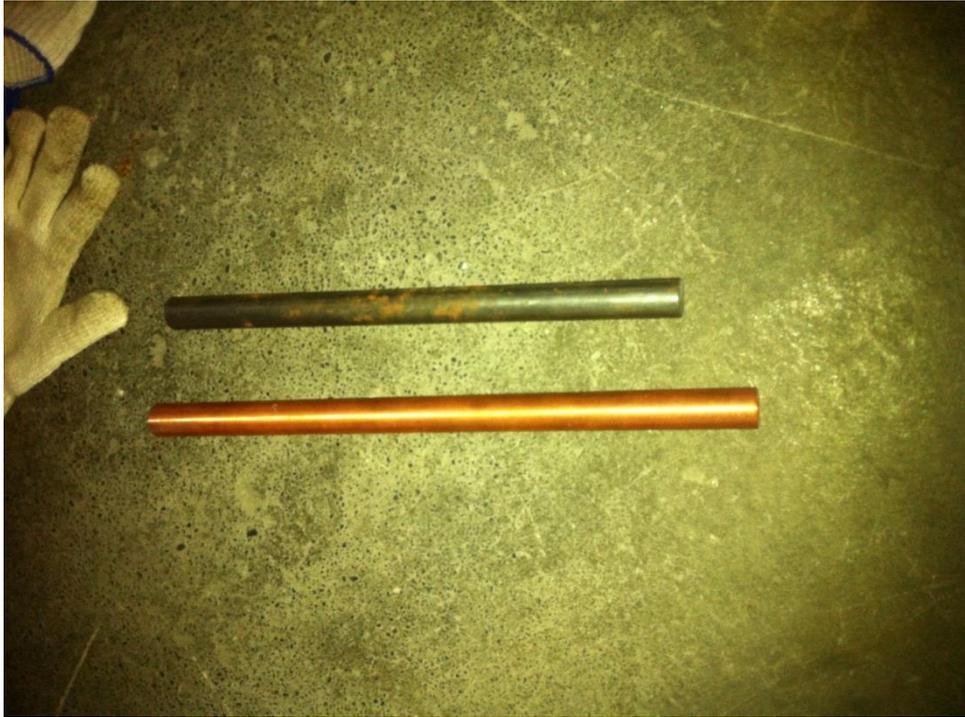
圖 4-7：銅抗彎與鑄鐵抗拉的標準試體
