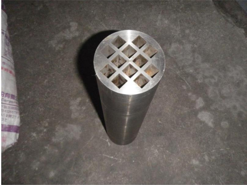
圖 4-9：BWR 鑄鐵廢棄物罐縮尺試體
