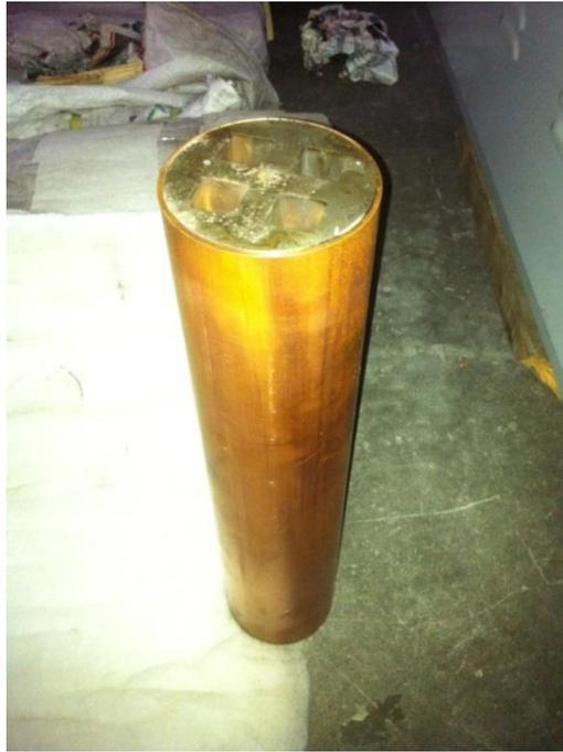
圖 4-11：組合後的廢棄物罐縮尺試體
