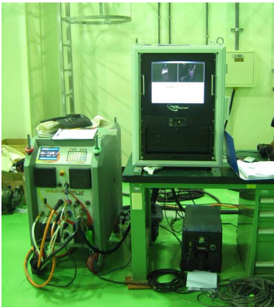
E. 自動銲接機、封銲測試用銲接平台 模擬結構上蓋銲道 模擬屏蔽上蓋銲道
